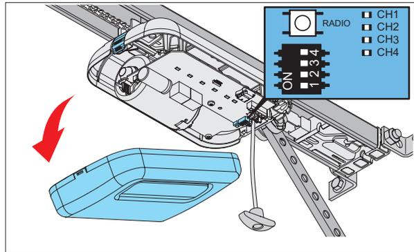
2. Retire la cubierta del carro.
