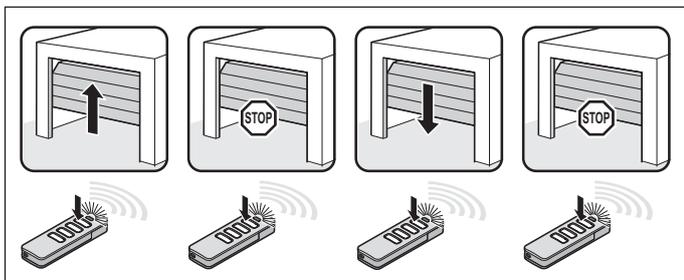
Fig. Secuencia de pulsos de puerta ABIERTA, puerta parada, puerta CERRADA, puerta parada
