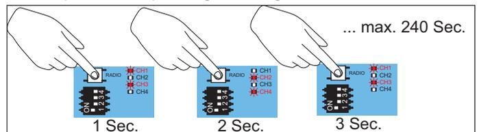
4. Cuente el tiempo apertura a través de los cambios de encendido de los LED. Cuando se alcance la duración deseada, suelte la tecla RADIO.
