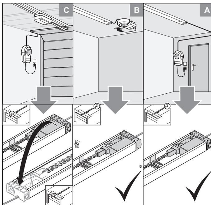
Fig. Variantes de montaje A, B y C
