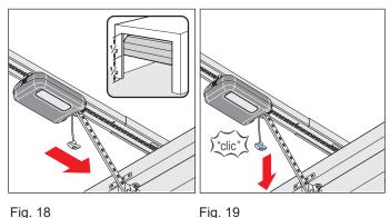
Fig. 18 Fig. 18. Move door to centre position.
