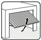
La puerta del garaje se abre y se cierra tirando horizontalmente del borde superior de la misma o empujándolo.
