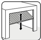
Puerta que no sobresale y que se desliza en el bastidor por un riel vertical.
