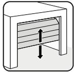
Tor, dessen Einzelsegmente in Laufschienen von der Senkrechten in die Waagerechte geschoben werden.
