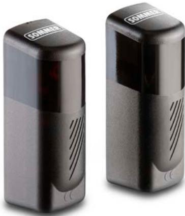
Die Einweg-Lichtschanke 20 m setzt auf das SOMMER 2-Draht-System. Dadurch sind auf Sender- und Empfängerseite nur zwei Drähte nötig, wobei die Polung beliebig ist. Durch die 180° drehbare Platine ergeben sich mehr Installationsmöglichkeiten und es werden keine Montagewinkel benötigt. Mit der Schutzart IP55 ist sie für den Einsatz im Freien geeignet.
